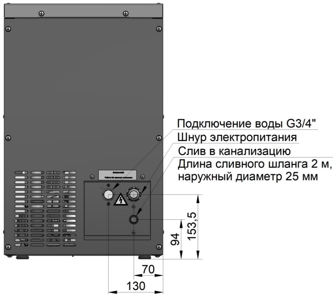
Рис. 5 Схема подключения льдогенератора
